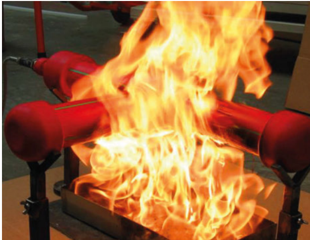
Δοκιμή VDS Γερμανίας απευθείας στη φωτιά θερμοκρασία 460°C /εσωτερική πίεση 12 bar
