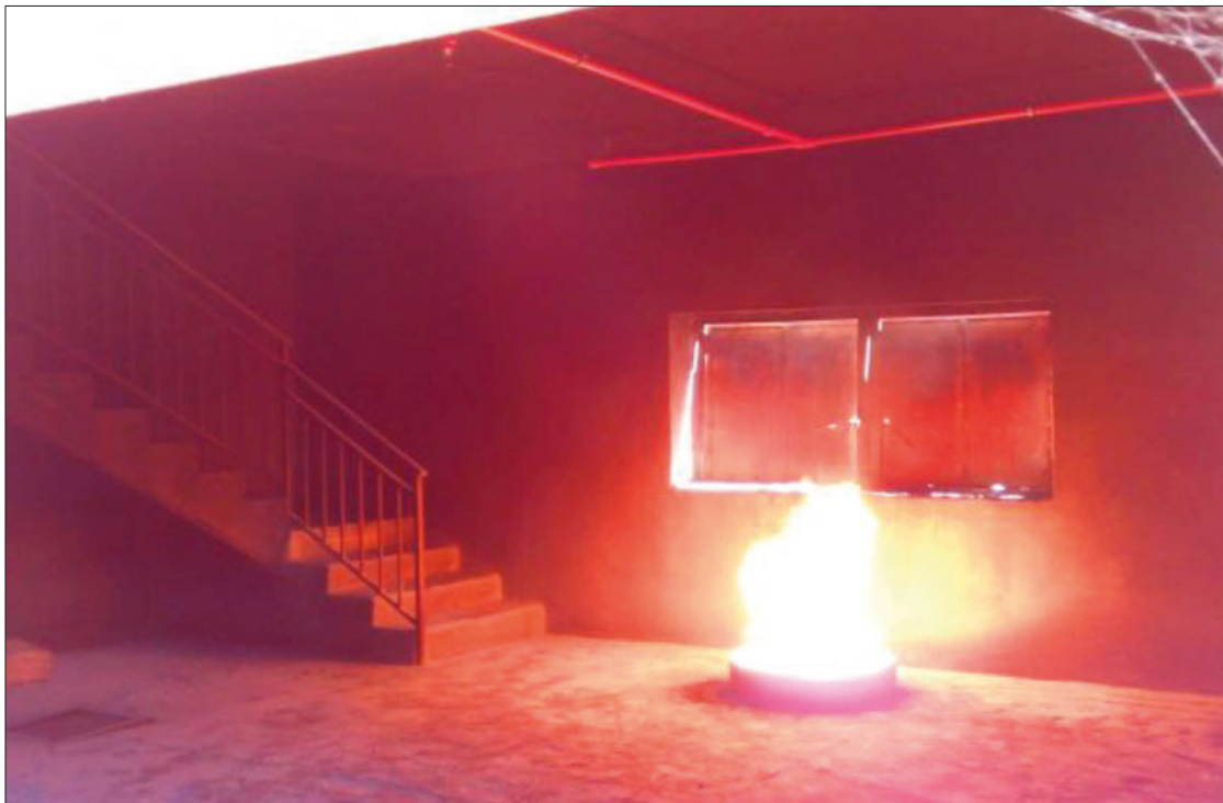
Δοκιμή LPCB Βρετανίας σε δίκτυο sprinkler σε fire test room
